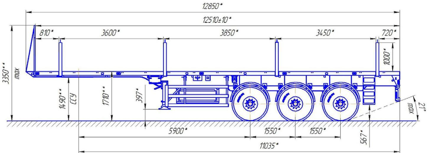
**НА СХЕМЕ ПОЛУПРИЦЕП БЕЗ БОРТОВ**
